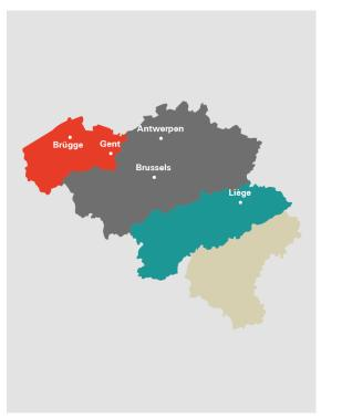
See NBN EN 1991-1-4, Figure 4.3 ANB – Vitesses de reference du vent  $v_{b,0}$  définies par zones
